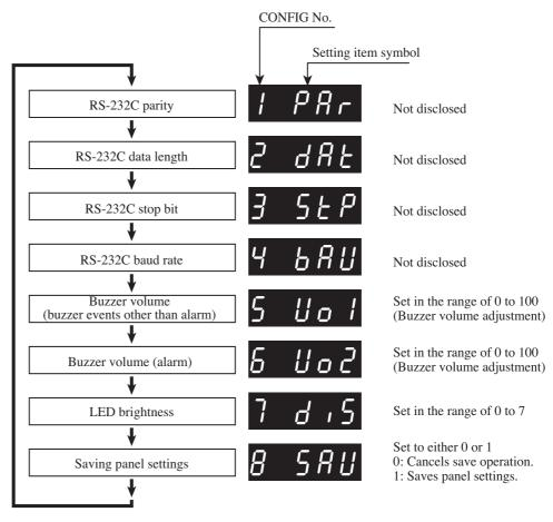
Fig. 5-3 **CONFIG Setup**
