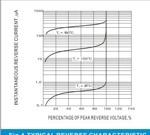
Fig.4-TYPICAL REVERSE CHARACTERISTIC
