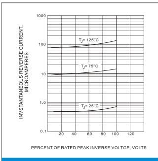
FIG.3 TYPICAL REVERSE CHARACTERISTICS
