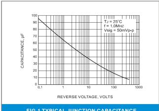
FIG.1 TYPICAL JUNCTION CAPACITANCE
